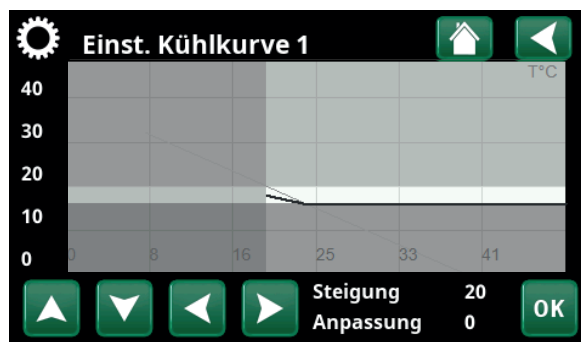
Menü „Fachmann/Einstellungen/Kühlung/Kühlkurve/Einst. Kühlkurve“.
