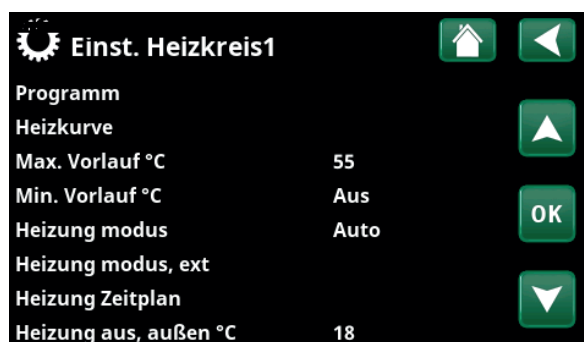
Menü: „Fachmann/Einstellungen/Heizkreis“ In der Menüleiste „Heizung Modus, ext“ wird die Fernsteuerung für den Heizkreis festgelegt. Zugriff auf das Zeitplan erhalten Sie über die Menüleiste „Heizung Zeitplan“.
