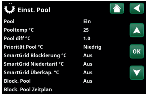
Menü: „Fachmann/Einstellungen/Pool“ Die Pooltemperatur steigt um 5 °C, wenn SmartGrid Niedertarif aktiviert ist.
