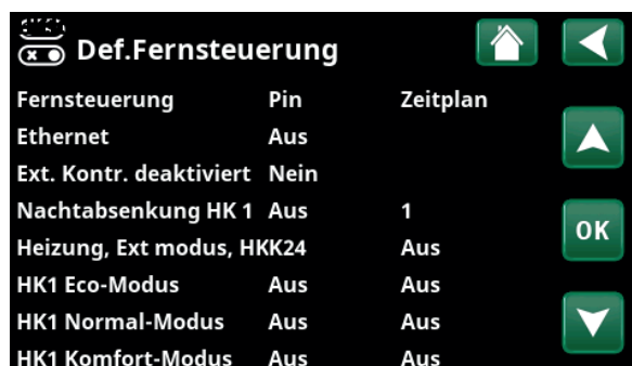
Ausschnitt aus dem Menü „Fachmann/Definieren/Fernsteuerung“
