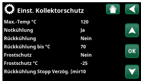
Menü: „Fachmann/Einstellungen/Solarkollektoren/Kollektorschutz“
