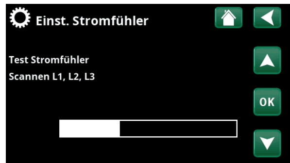
Menü: „Fachmann/Einstellungen/Stromsensoren/Auto-konfig. Stromsensoren“.
