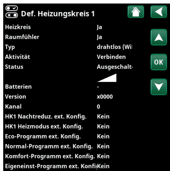
Menü: „Fachmann/Definieren/Heizkreis/Heizkreis 1“. Drahtloser Raumfühler ausgewählt
