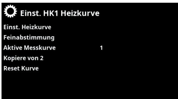
Menü „Erweitert/Einstellungen/Heizkreis/Heizkreis 1/Heizkurve“. Aktive Messkurve: #1.
