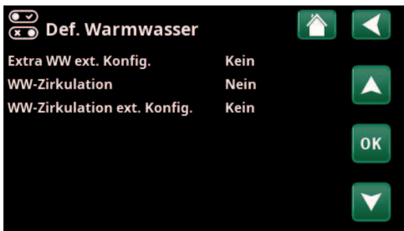
Menü: „Erweitert/Definieren/WW“. In der Menüleiste „Extra WW“ wird der Normalmodus für das externe Steuersignal festgelegt („Normal offen (NO)“ oder „Normal geschlossen (NC)“).
