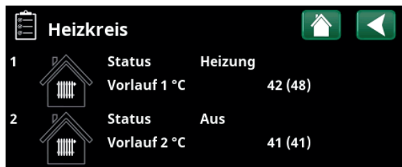
Menü: „Betriebsdaten Heizkreis“ Im Menü werden die aktuellen Temperaturen und der Status festgelegter Heizkreise angezeigt.
