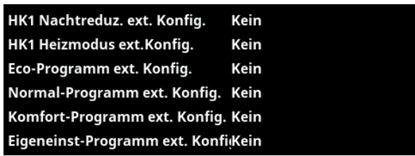
Ausschnitt aus dem Menü „Erweitert/Definieren/Heizkreis“. In den Menüleisten „Programm Eco / Normal / Komfort / Eigene Einstellungen ...“ wird der Normalbetriebs-Modus durch das externe Steuersignal („Schließer (NO)“ oder „Öffner (NC)“) angezeigt.
