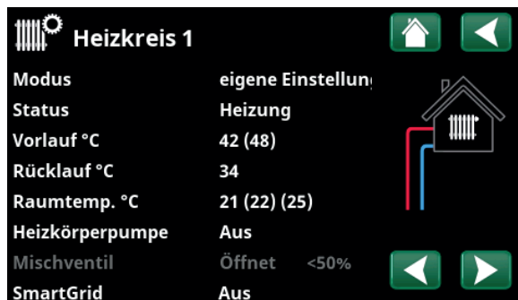
Das Menü zeigt detaillierte Betriebsdaten des ausgewählten Heizkreises an. Zur Anzeige festgelegter Heizkreise die Pfeiltasten anklicken oder seitlich wischen.
