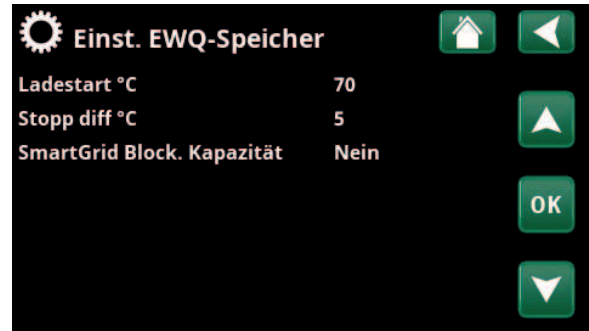
Menü: „Erweitert/Einstellungen/Externe Wärmequelle“.
