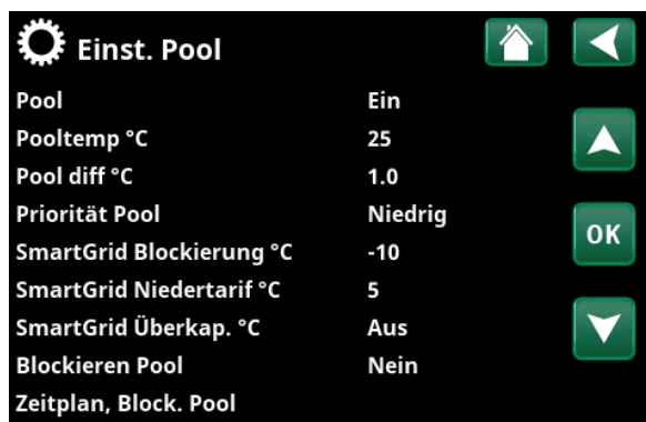
Menü: „Erweitert/Einstellungen/Pool“. Die Pooltemperatur steigt um 5 °C, wenn SmartGrid Niedertarif aktiviert ist.
