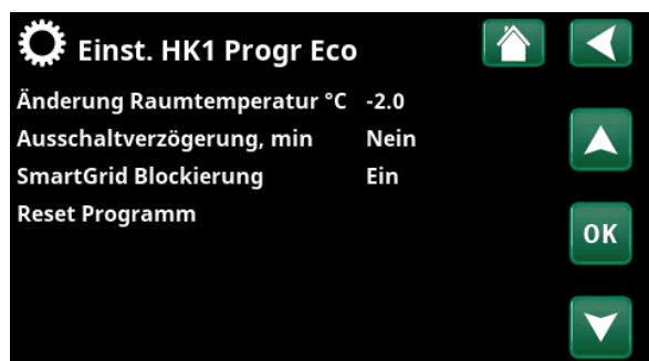
Menü „Erweitert/Einstellungen/Heizkreis/Heizkreis 1/Programm/Eco“.
